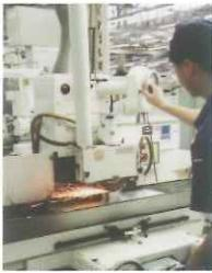
平面研削盤作業の実施風景
