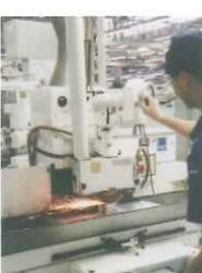
平面研削盤作業の実施風景
